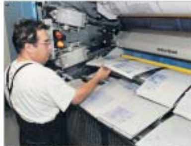
Die entwickelten Druckplatten werden auf den Farbtrapezladen gespannt.
