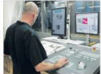
Steuerpult der Druckmaschine. Von dieser Station aus wird die ganze Maschine gesteuert.
