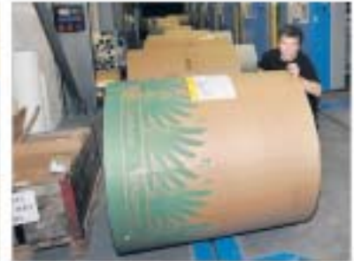
Die Papierrollen werden aus dem Rollenlager an die Druckmaschine gebracht.
