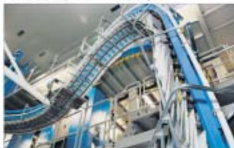
Die gedruckten Produkte werden über die Förderanlage in die Speicher transportiert.
