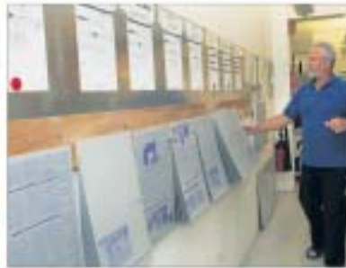
Die fertigen Druckplatten werden nach dem entsprechenden Produkt sortiert und für den Druck bereitgestellt.
