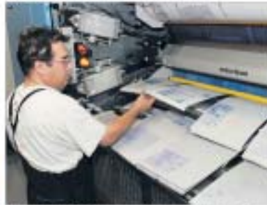
Die verschickten Druckplatten werden auf den Platzspindeln gespannt.
