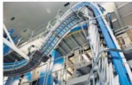
Die gedruckten Produkte werden über die Fördereinlage in die Spedition transportiert.
