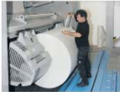
Vorbereitung der Papierrolle zum Einlegen in die Druckmaschine.
