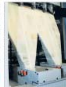
An Falzblech bekornt die Zeitung den Längsfalz.
